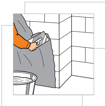
Afbeelding 17: Bij schoorsteenmuren wordt de laag gipslijm aangebracht op het metselwerk, waarop de FERMACELL plaat wordt vastgedrukt
