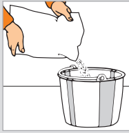
Afbeelding 23: FERMACELL voegengips in het water strooien
